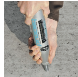
เครื่อง Rebound Hammer Test
