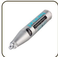
Rebound Hammer เครื่องวัดกำลังอัดคอนกรีต
